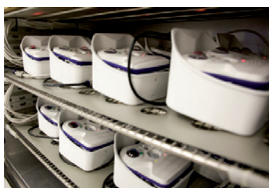
Každá kamera se před odesláním testuje při extrémních teplotách.
